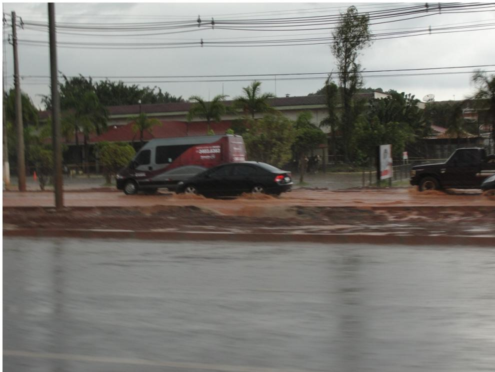
Fig. - Acúmulo de água na via marginal por inexistência de drenagem pluvial
