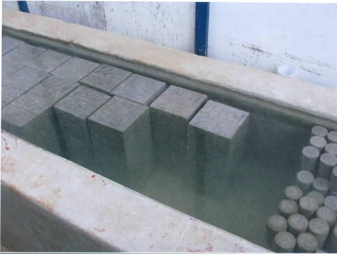
Fig. 15 – Corpos de prova prismáticos no tanque de água e cal
