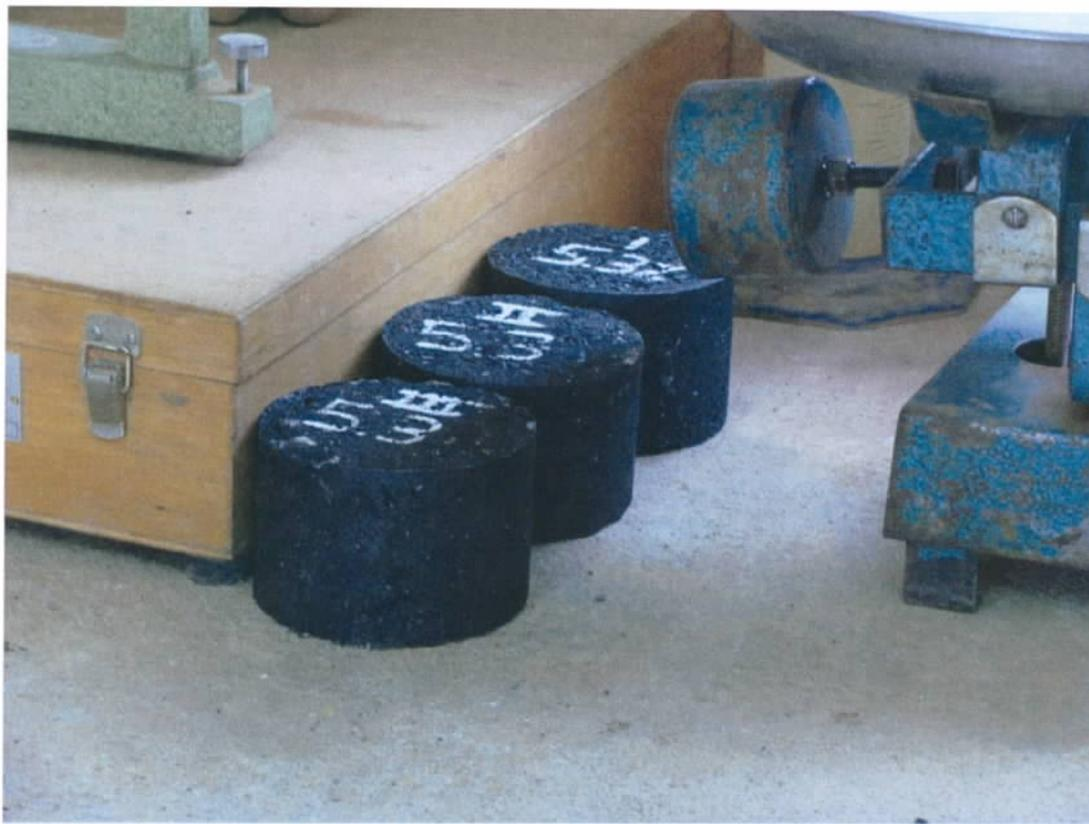
Fig. 23 – Corpos de prova de CBUQ
