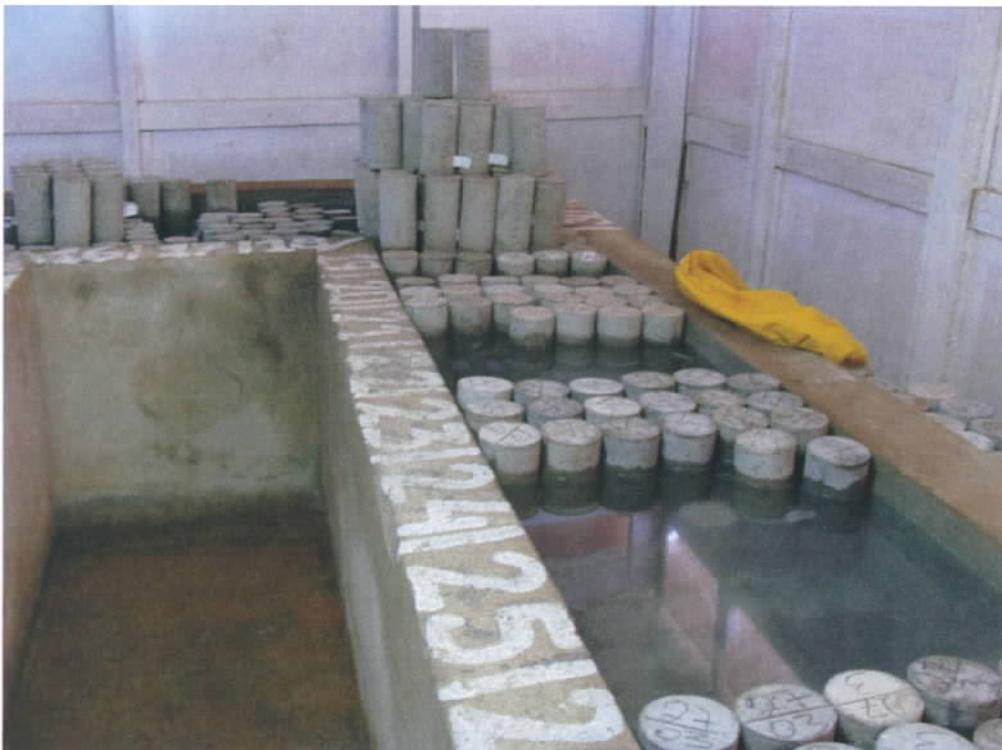
Fig. 12 – Tanques de estocagem dos corpos de prova
