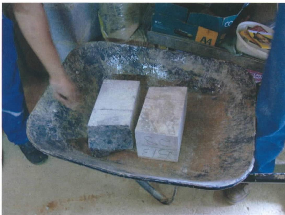
Fig. 20 – Corpo prismático de concreto ensaiado
