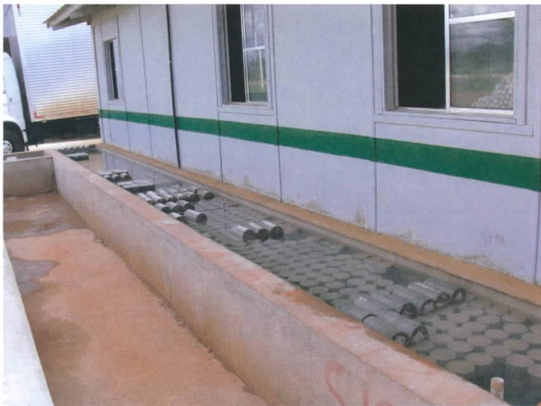
Fig. 26 – Tanque de estocagem de corpos de prova de concreto
