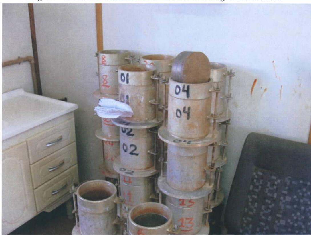
Fig. 22 – Formas para moldes de corpos de prova de CBUQ
