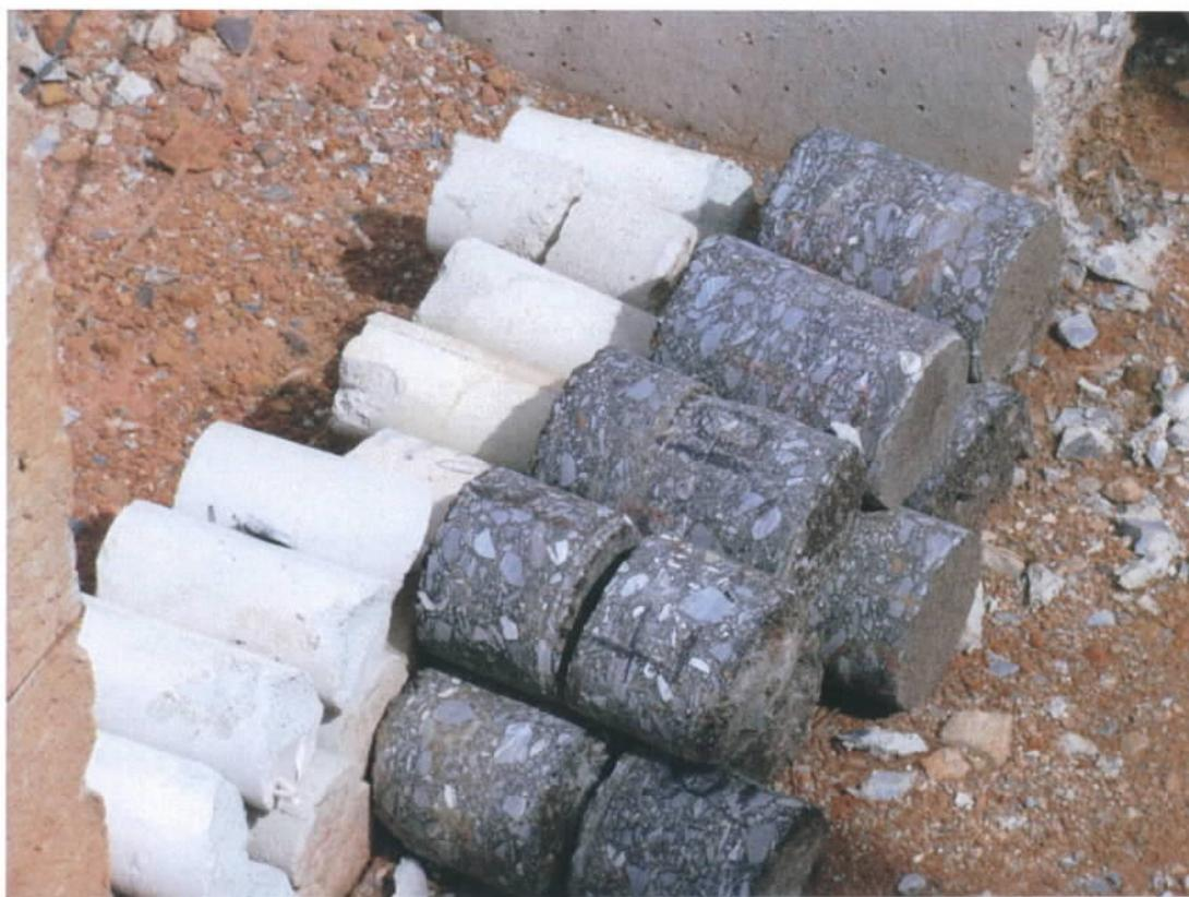
Fig. 28 – Corpos de prova de concreto e de CBUQ
