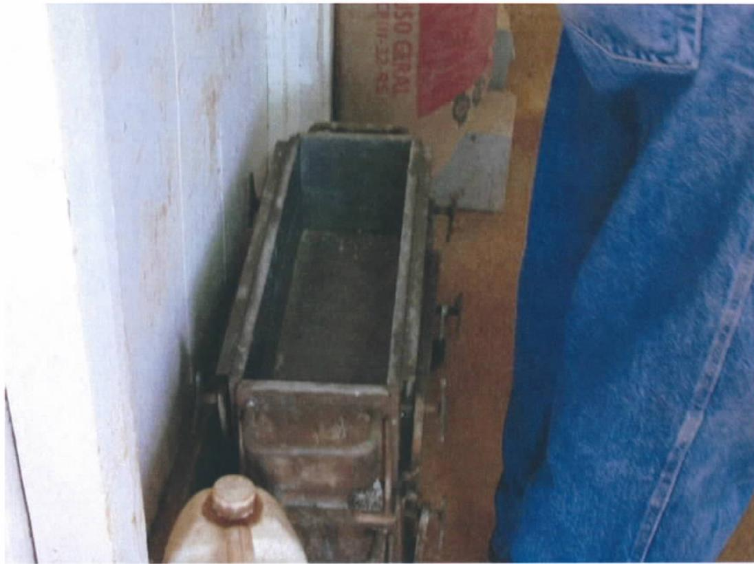
Fig. 14 – Formas para moldagem de corpos de prova prismáticos do pavimento rígido
