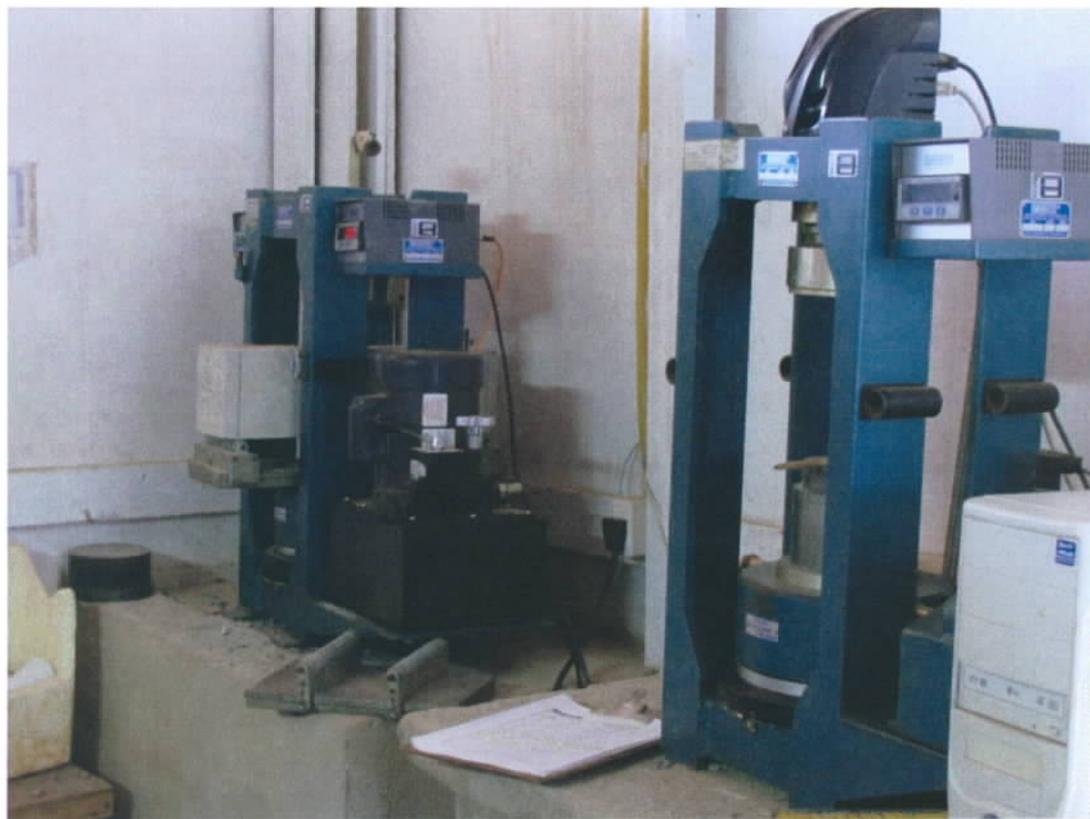
Fig. 18 – Prensas hidráulicas para ensaio de resistência a tração por flexão (a esquerda) e de resistência a compressão axial (a direita)
