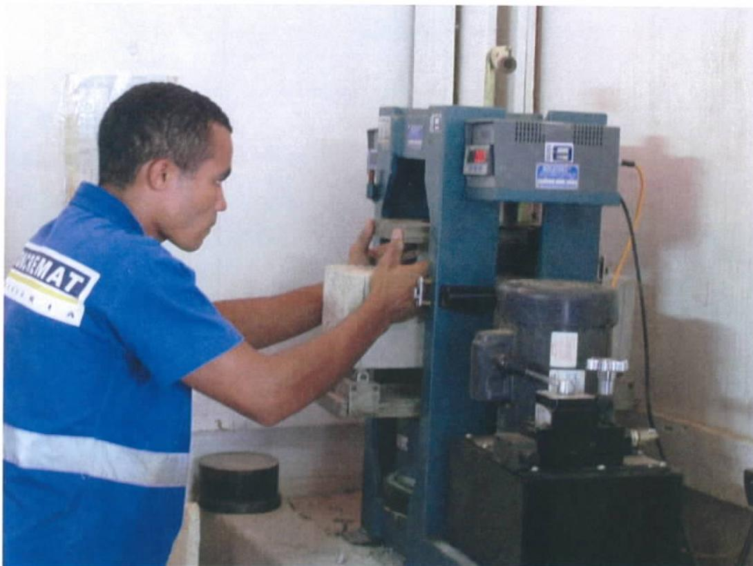
Fig. 19 – Ensaio de resistência a tração por flexão em corpo prismático de concreto do pavimento rígido
