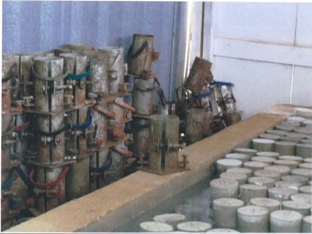
Fig. 13 – Formas para moldagem dos corpos de prova
