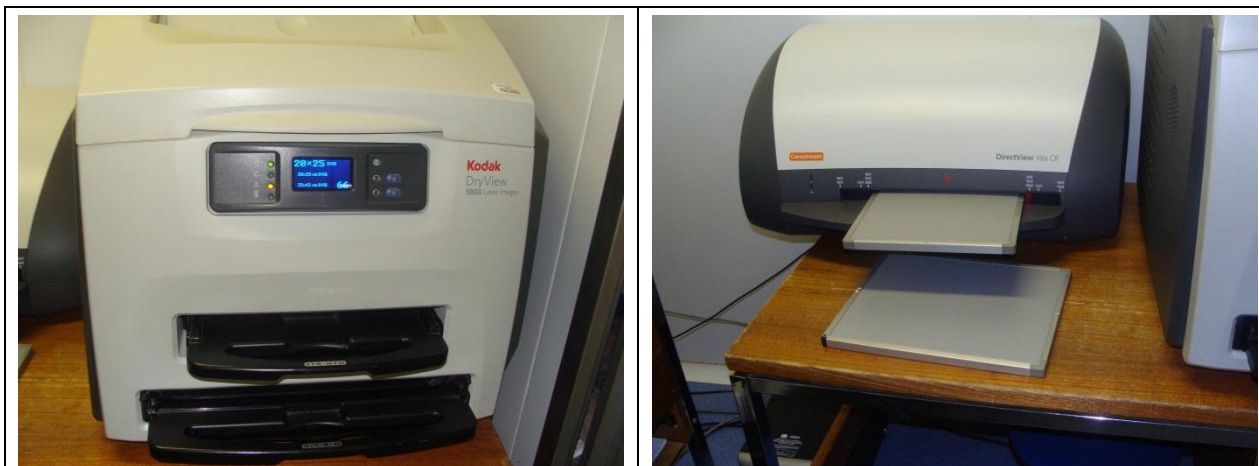
Fotos 40 e 41: UPA Núcleo Bandeirante – sistema de digitalização para o RX fixo local
