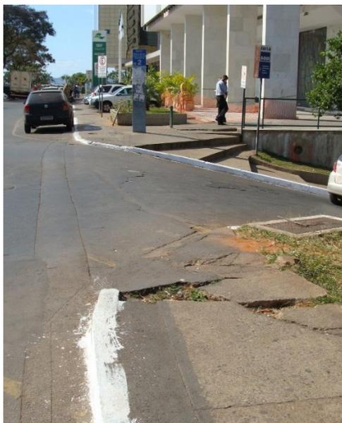
Figura 59- Ausência de rampa na travessia de via ao longo do trajeto para a AGEFIS RAFs 1 e 3 em Brasília.
