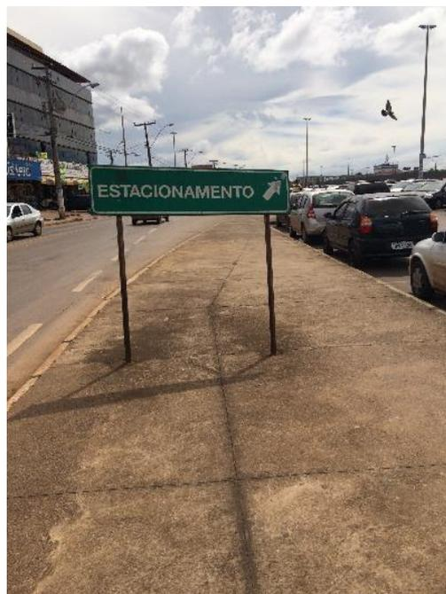
**Figura 56 - Placa de sinalização interferindo no passeio e sem alerta com piso tátil no trajeto para a Estação Ceilândia Terminal.**
