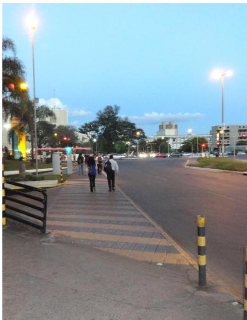
**Figura 33 – Rebaixamento da guia para acesso de veículos desrespeitando o passeio no trajeto para o Procon de Brasília**
