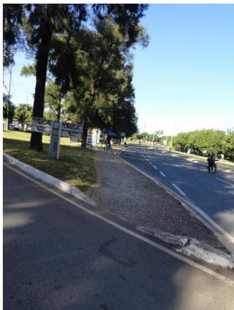
**Figura 62 - Rampa inadequada no trajeto para o Hospital do Guar.**
