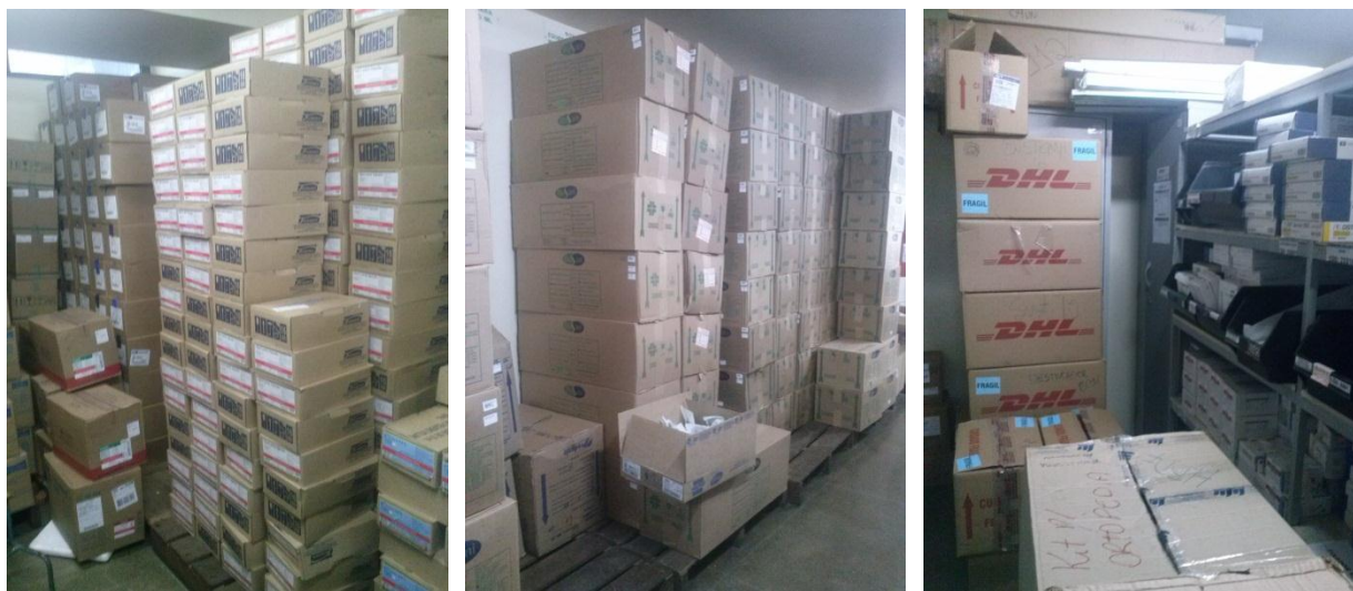
Figura 4: Hospital de Base do Distrito Federal – pouco espaço para organização, teto baixo, produtos encostados nas paredes, piso inadequado e empilhamento sem amarração.
